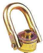
Manilha articulada. SWL: 0.5 a 16.9 ton. De M8 a M48. Existe em rosca de polegada.
